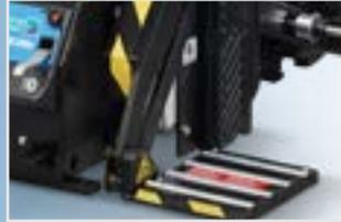
Operado por pedal con plataforma de rodillos integrada facilita el levantamiento de ruedas pesadas, minimizando efectivamente la fatiga del técnico y aumentando la productividad general.
